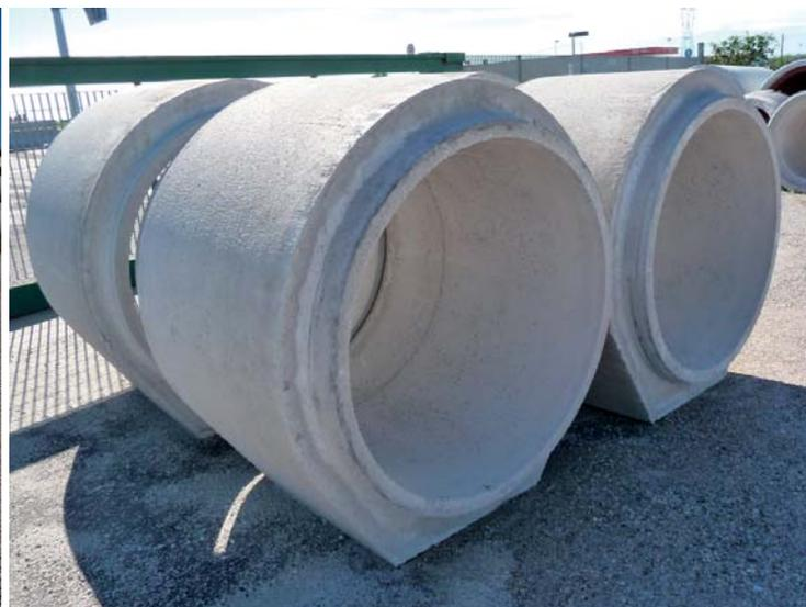
Il tubo maschio-maschio rappresenta una valida soluzione in quanto facilita l'innesto dei tubi stessi nei pozzetti di ispezione garantendone contemporaneamente una maggiore tenuta. Offre, inoltre, la possibilità di adoperare pozzetti di dimensioni inferiori rispetto a quelli che verrebbero usati nel caso si dovesse innestare la parte a bicchiere.
