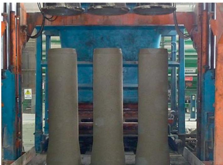
TUBI circolari vibrocompressi con giunto a bicchiere da ml. 2 armati
