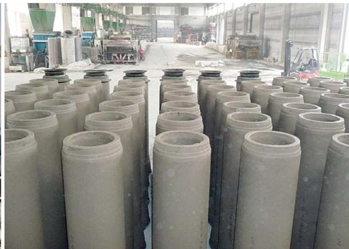
Tubi vibrocompressi a bicchiere armati da ml. 2
